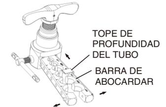
3. Inserte el tubo en el orificio correcto según su diámetro y tamaño marcados en el bloque abocardador. Asegúrese de que el tubo se introduce hasta el tope de profundidad antes de apretarlo. Asegúrese de colocar primero la tuerca de abocardado.
